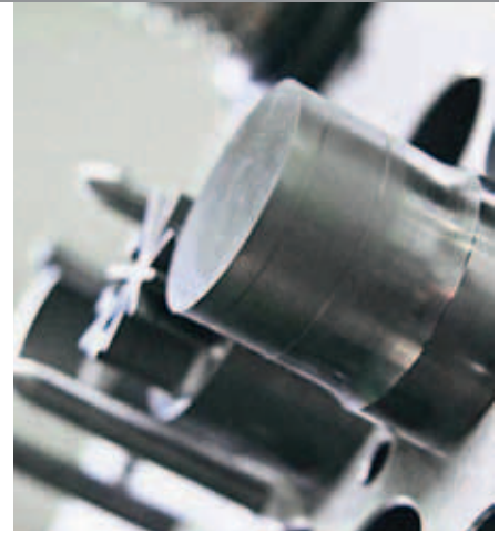
Ein Ansatz für die PEM-Technologie sind Standard-Stempel, die nachträglich mit einem Hinterschnitt versehen werden
