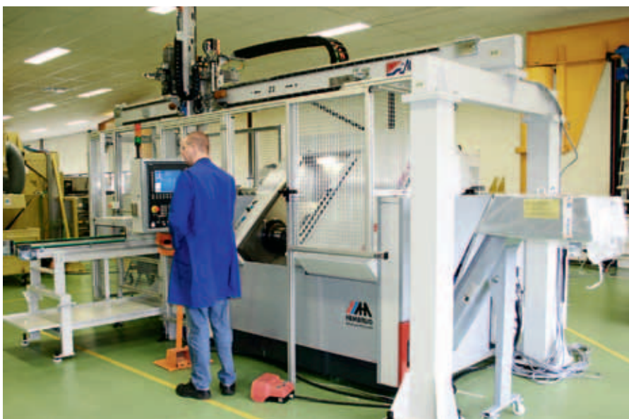
Die Mikroturn® 100 CNC – bewährte Technologie von Hembrug. Mit der hydrostatischen Hauptspindel ist nun auch die Bearbeitung größerer Werkstücke horizontal möglich.
