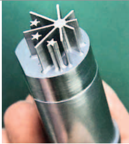
Ein Stanzwerkzeug mit Hinterschnitten, die mit keinem anderen Verfahren herstellbar sind
